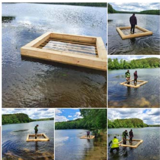
Testowanie pływających wysp, które zostaną zainstalowane na zbiornikach po eksploatacji torfu w kopalni Krakulice. Fot. Wojciech Spychała
